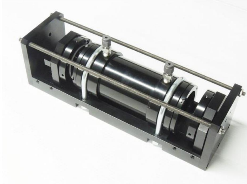
Cellule à gaz OELPC-100 avec chambre isolée intégrée
